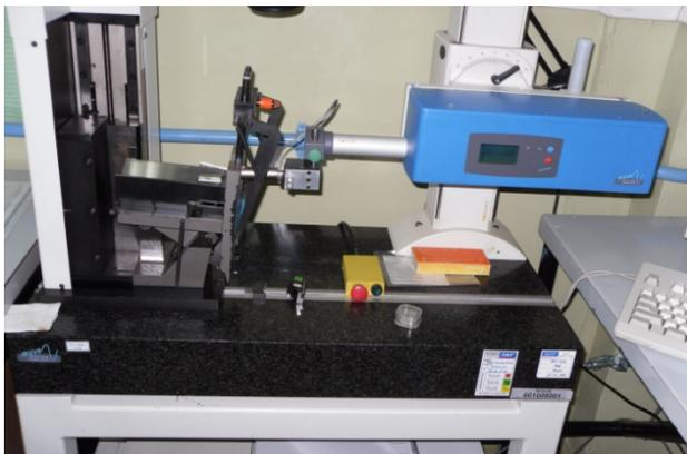
Рис. 5. Прилад MEF100C для знаходження профілю доріжки кочення ролика
