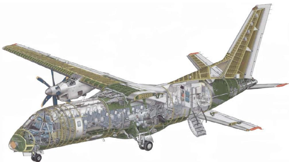
Рис. 1. Конструкция самолета Ан-140
