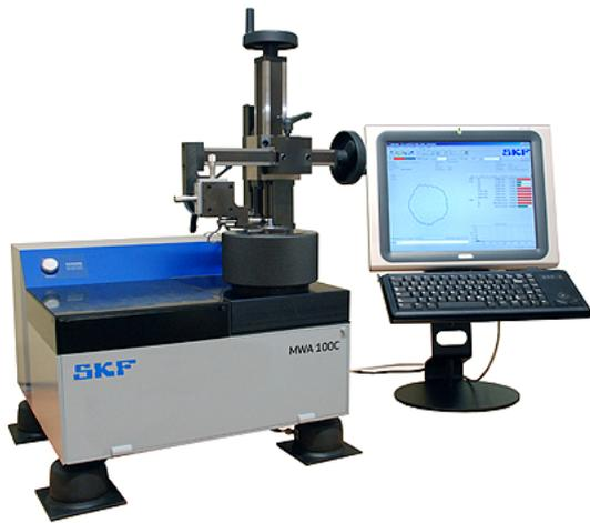
Рис. 7. Прилад MWA100C для вимірювання мікрогеометрії доріжки кочення ролика
