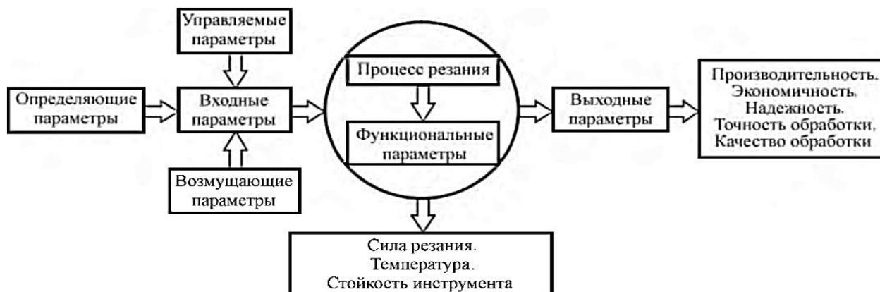
Рис. 1. Структурная модель процесса резания
