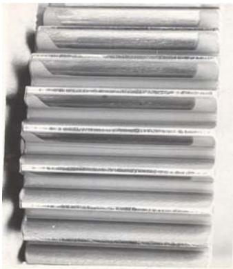
Рис. 2. Зубчатое колесо с продольными трещинами во впадине
