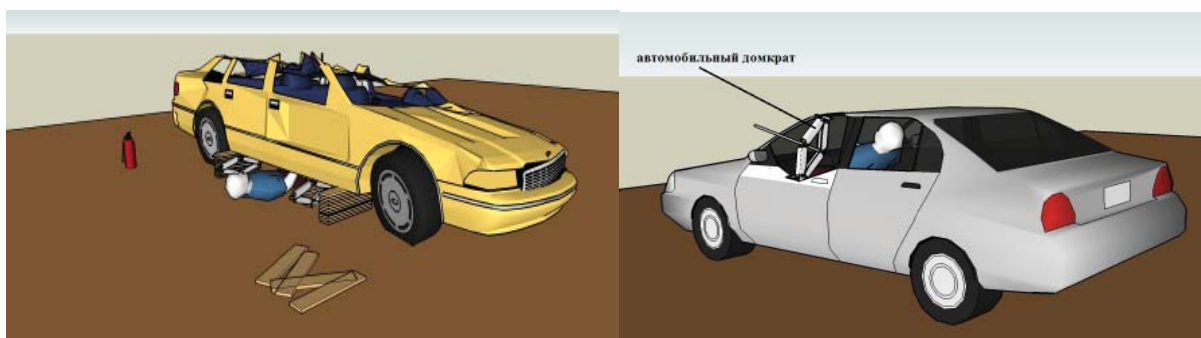
а) б) Рис. 3. Деблокирование пострадавшего: а – подъем автомобиля с пострадавшего, б – подъем крыши автомобиля с помощью домкрата
