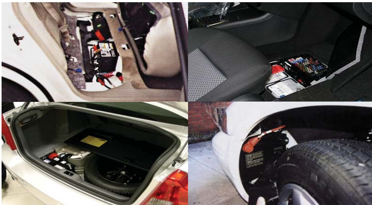
Рис. 1. Варианты расположения аккумуляторной батареи в автомобиле
