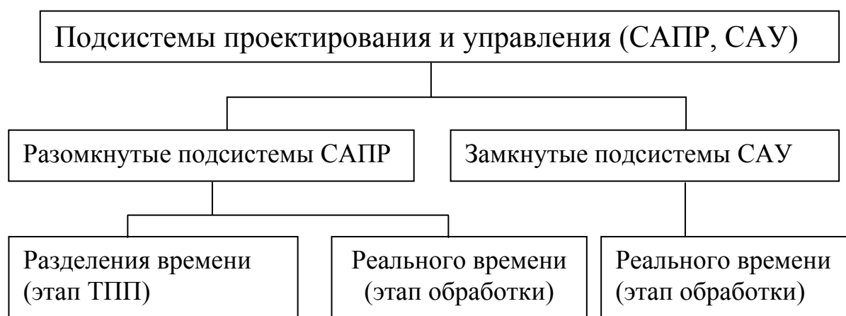
Рис.4.16. Классификация систем проектирования и управления по принципу работы: САПР – система автоматизированного проектирования (технологии); САУ – система автоматического управления (технологией).
