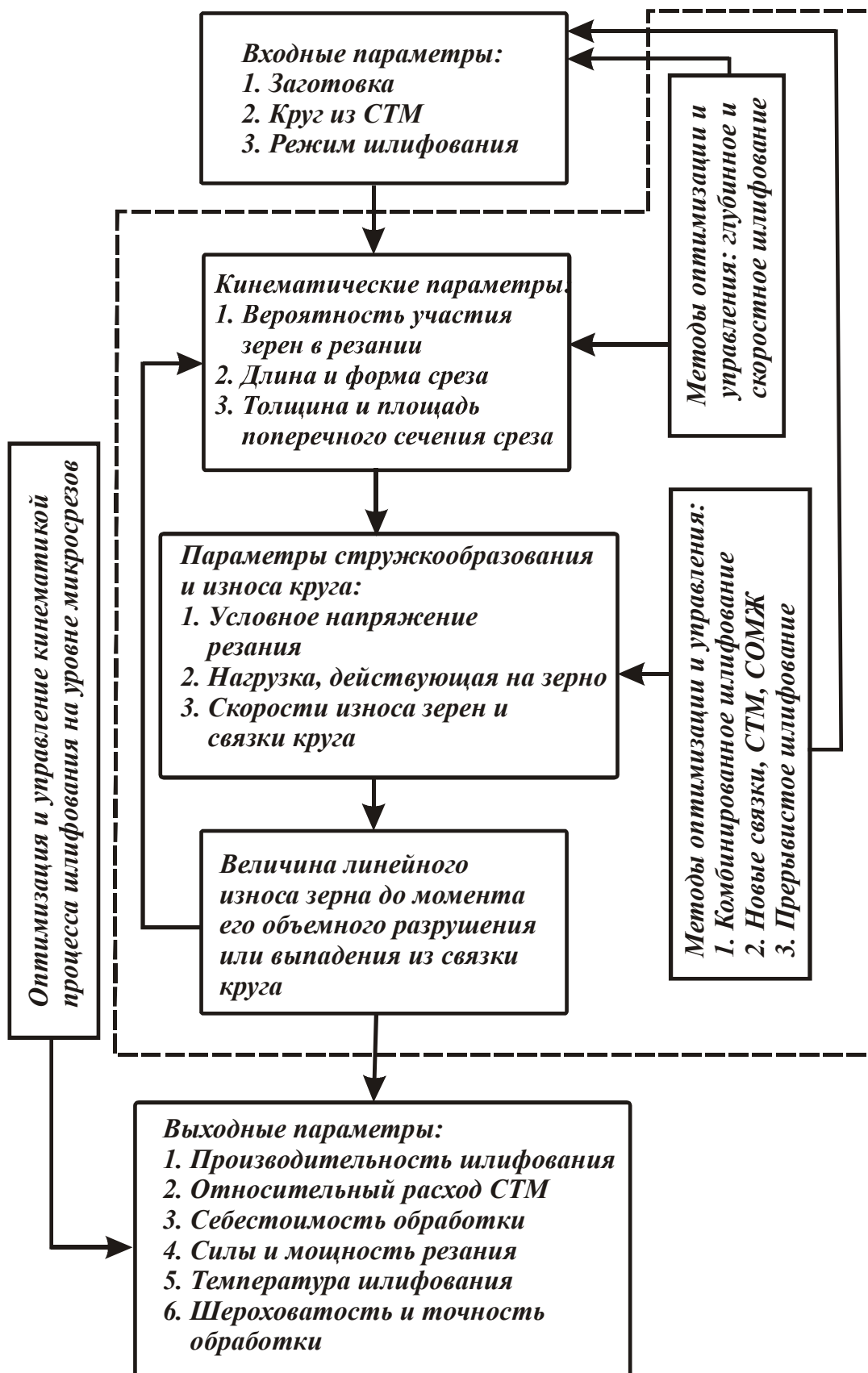
Рис. 1.8. Структурная схема оптимизации управления кинематикой процесса шлифования на уровне микросрезов.
