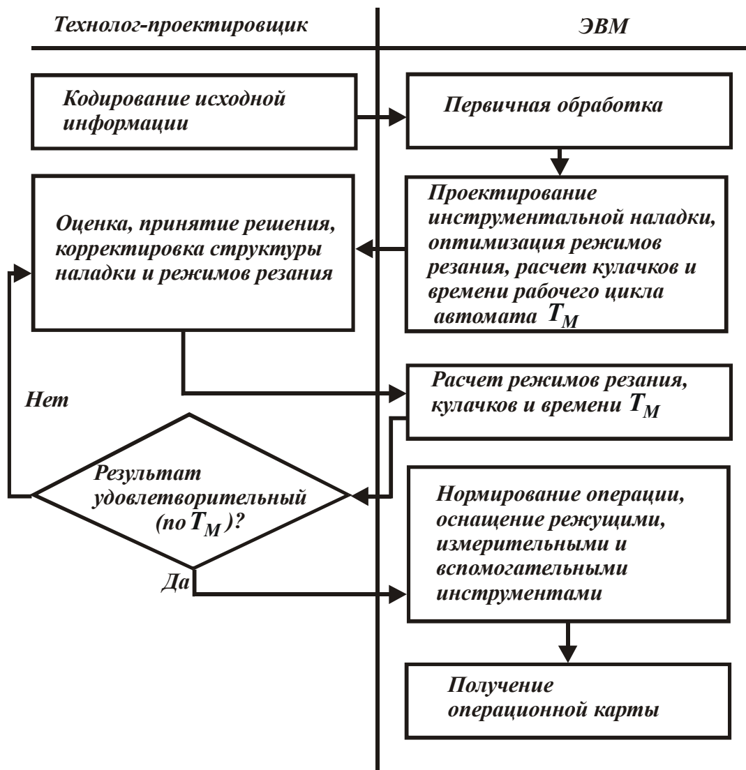
Рис. 1.11. Схема взаимодействия технолога-проектировщика и ЭВМ при проектировании автономной операции.
