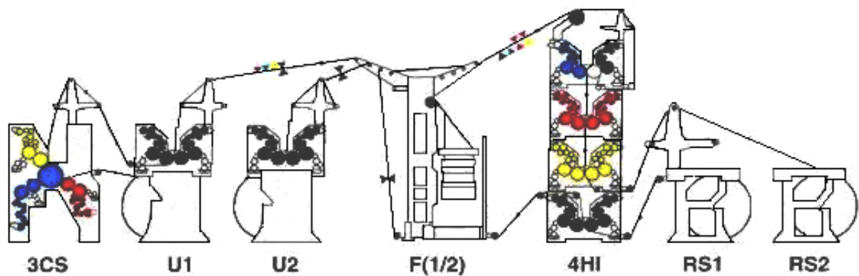
Рис. 1.2. Багатомодульна конструкція що забезпечує проходження друкарського полотна (тут: 3CS – трифарбовий модуль із центральним друкарським циліндром; U1, U2 – двофарбові модулі з вбудованою рулонною зарядкою; F(1/2) – фальцапарат; 4HI – башта з чотирьох двофарбових модулів; RS1, RS2 – дві окремі рулонні зарядки або пристрої автоматичної зміни рулонів)
