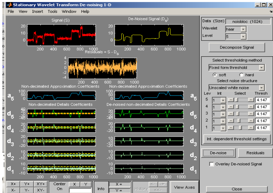
Рис. 4.35. Окно после нажатия кнопки SWT DE – NOISING 1 –D удаление шума стационарного одномерного сигнала
