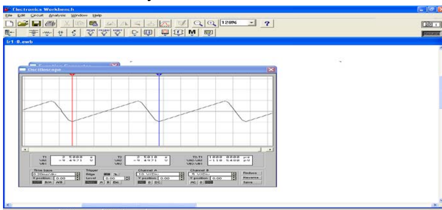
Рис. 1.30. Измерение длительности пилообразных импульсов
