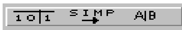
Рис. 4.9. Кнопка для получения минимизированной (упрощенной) логической функции прибора, осуществляющего формирование сигнала четности
