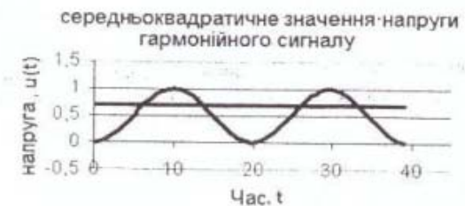
Рис. 4. Графіки, що показують, як визначається і чому дорівнює середньоквадратичне значення гармонійного сигналу за період
