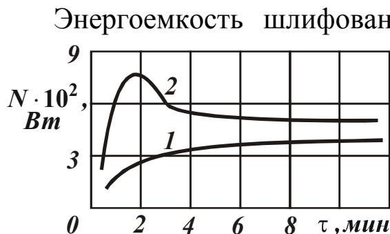
Рис. 2.25. Зависимости мощности шлифования N от времени обработки \tau : обрабатываемый материал – твердый сплав Т5К10; 1 - t = 0,03 мм; 2 - t = 0,05 мм.
