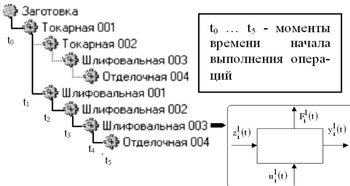
Рис. 5.5. Временной граф-дерево формирования технологического процесса получения поверхности детали.
