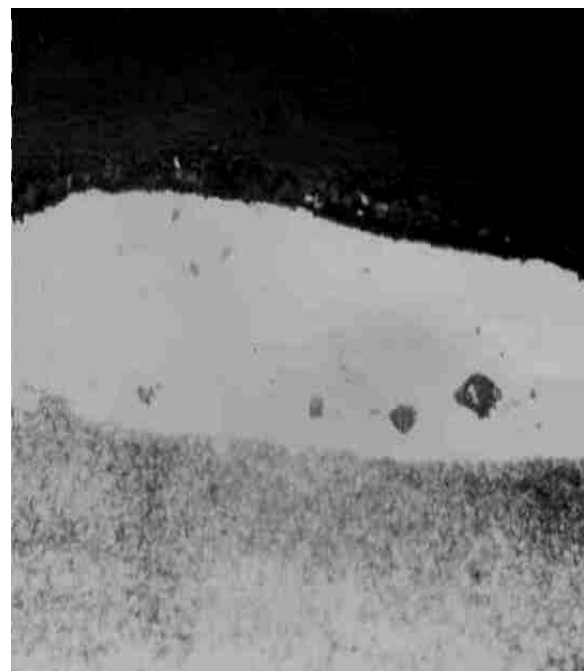
Рис. 4.8. Микроструктура образца из стали 38ХНЗМФ легированного Ni.
