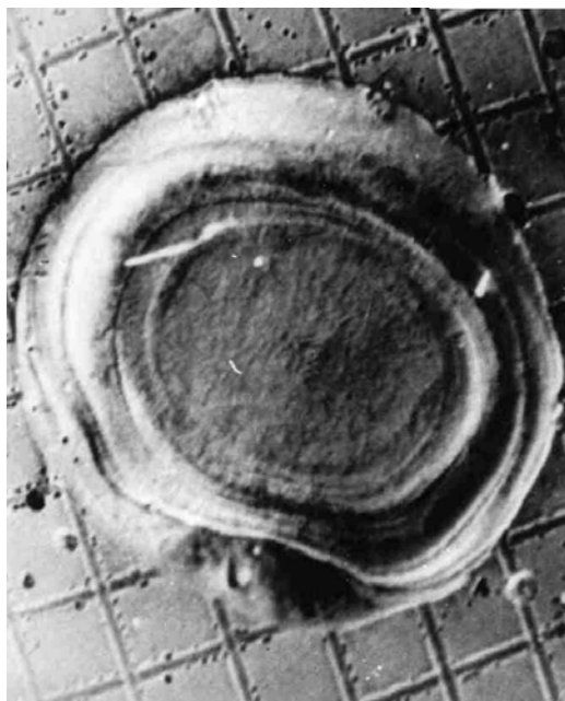
Рис. 4.16. Характер покрытия в масляной аэрозоли.
