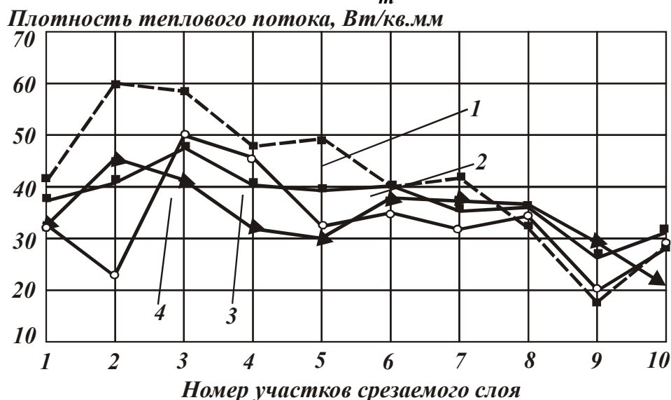
Рис.5.15. Распределение плотности теплового потока по участкам срезаемого слоя: 1, 2, 3, 4- на 1-ом, 2-ом, 3-ем и 4-ом проходах.
