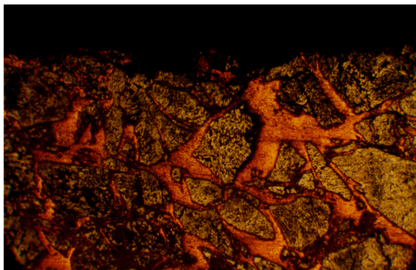
Рис. 3.14. Микроструктура композиции «твердый сплав «Релит» - медь».
