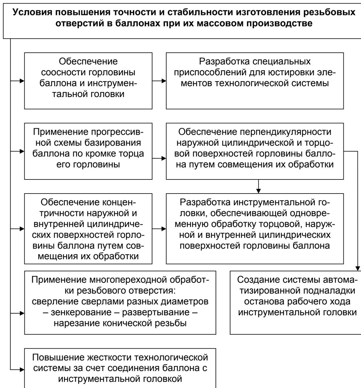
**Рис. 2.34. Структурная схема условий повышения точности и стабильности изготовления резьбовых отверстий в баллонах при их массовом производстве**
