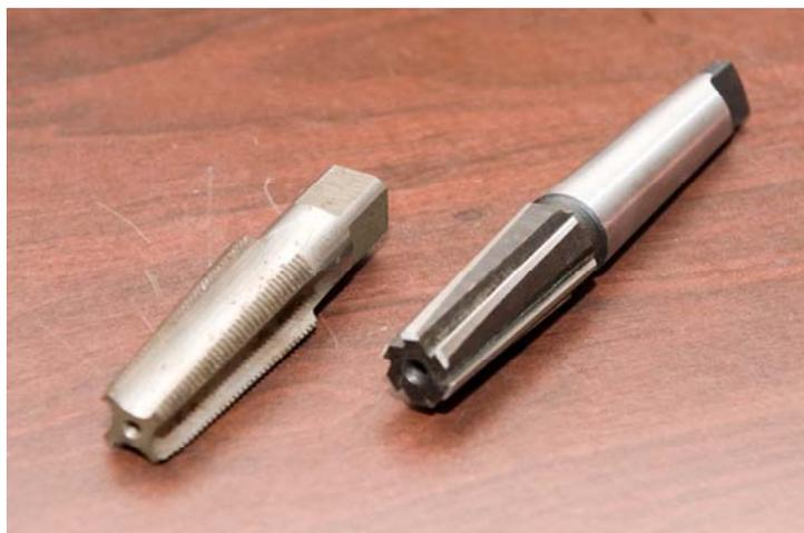
**Рис. 4.4. Конический зенкер и метчик  $w27,8$  мм по ГОСТ 9909-70**
