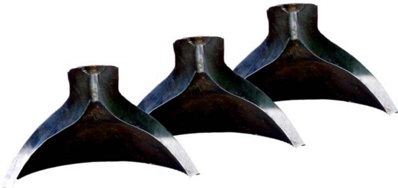
Рис. 1.4. Горловины баллонов в разрезе
