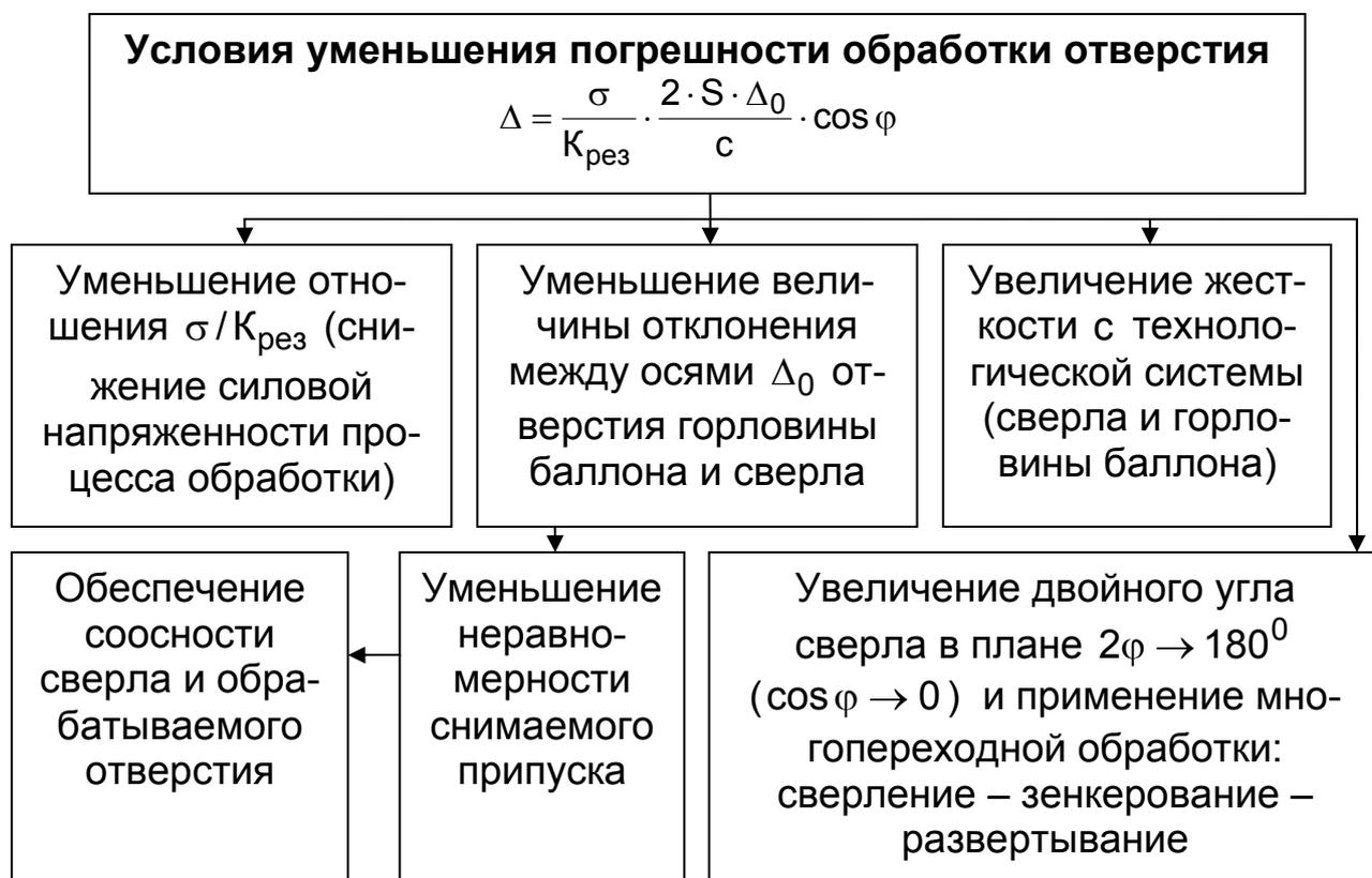
Рис. 2.14. Структурная схема условий уменьшения погрешности обработки отверстия с начальной значительной некруглостью
