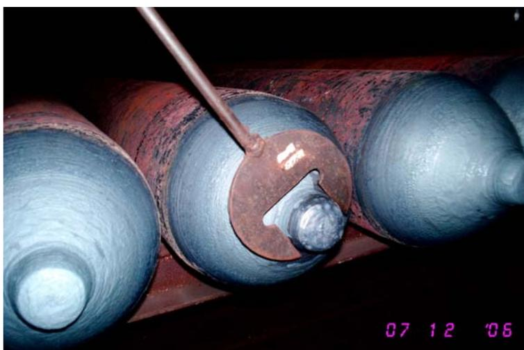
Рис. 4.1. Контроль диаметра цилиндрической части горловины баллона
