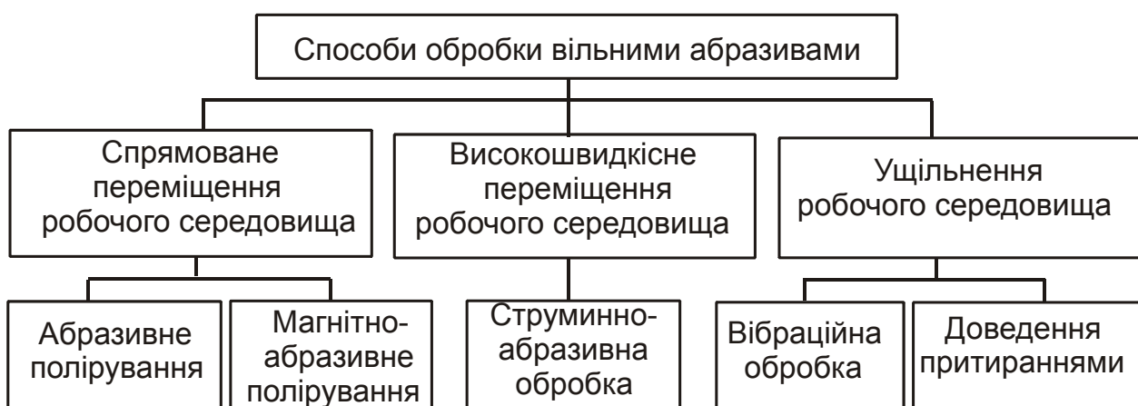
Рис. 1.17. Класифікація способів обробки вільними абразивами за характером дії абразивної частки
