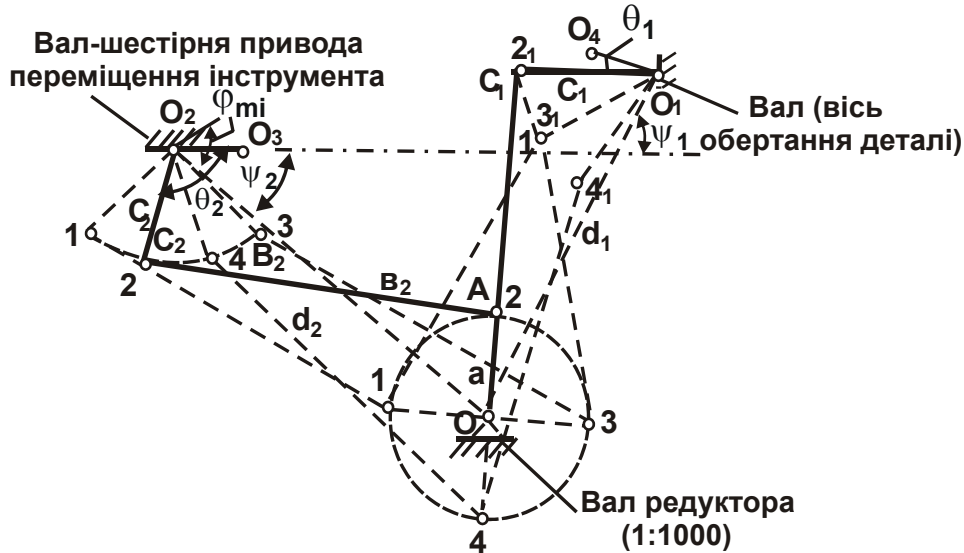
Рис. 4.38. Схема двох чотирьохланцюгових механізмів привода відносного переміщення абразивного інструмента та деталі
