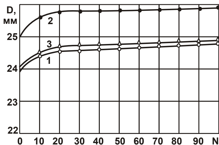
Рис. 4.28. Залежність діаметра довгомірних трубчастих елементів D від кількості намотувань на барабан діаметром 40 мм (36НХТЮ)
