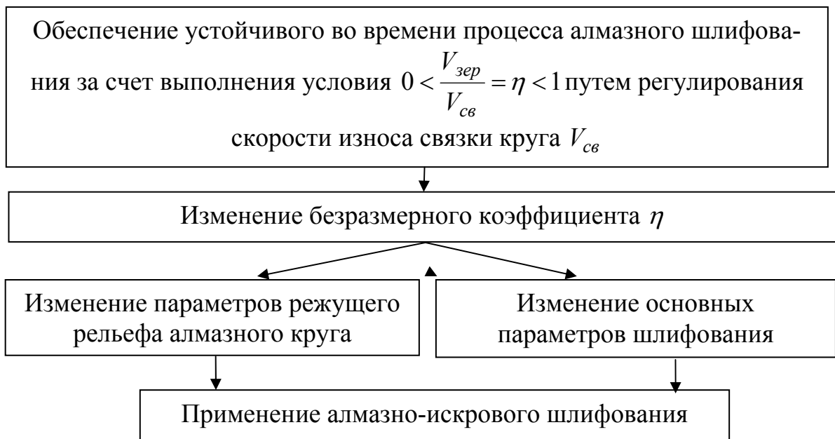
Рис. 3. Структурная схема, показывающая влияние скорости износа связки круга V_{св} на основные параметры шлифования.
