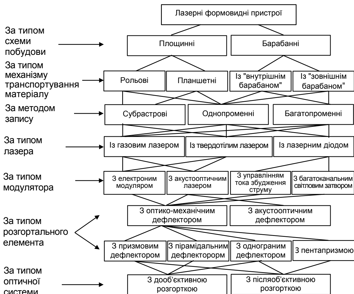
Рис. 9. Класифікаційна схема лазерних вивідних пристроїв для виготовлення фотографічних і друкарських форм
