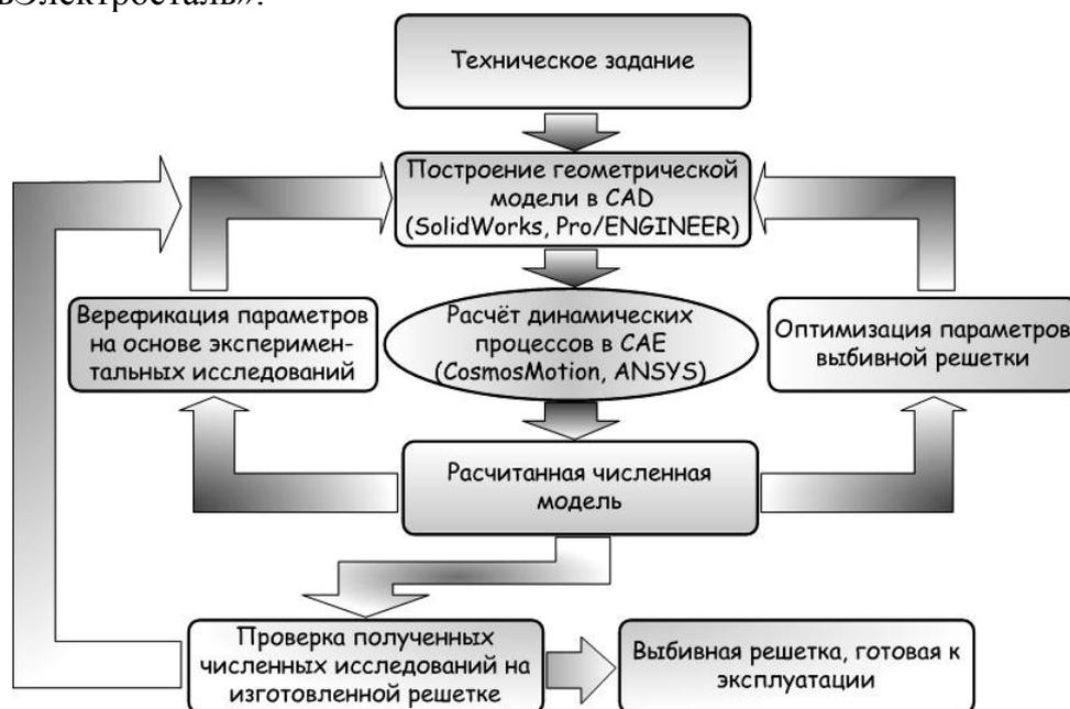
Рис. 2. Общая схема исследования динамических характеристик выбивной машины.
