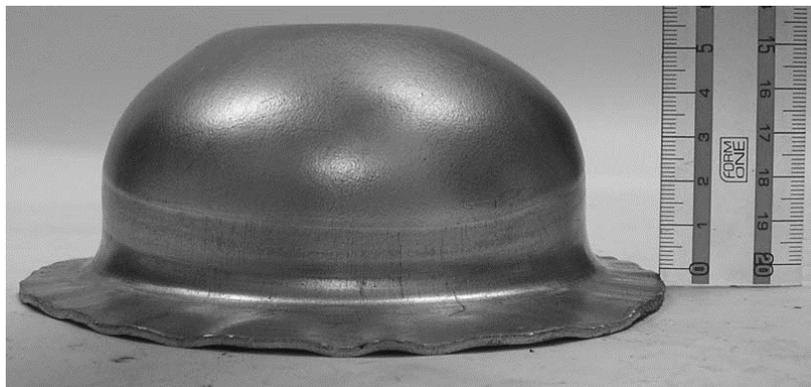
Рис.4 Форма детали после выполнения 1-го перехода штамповки.
