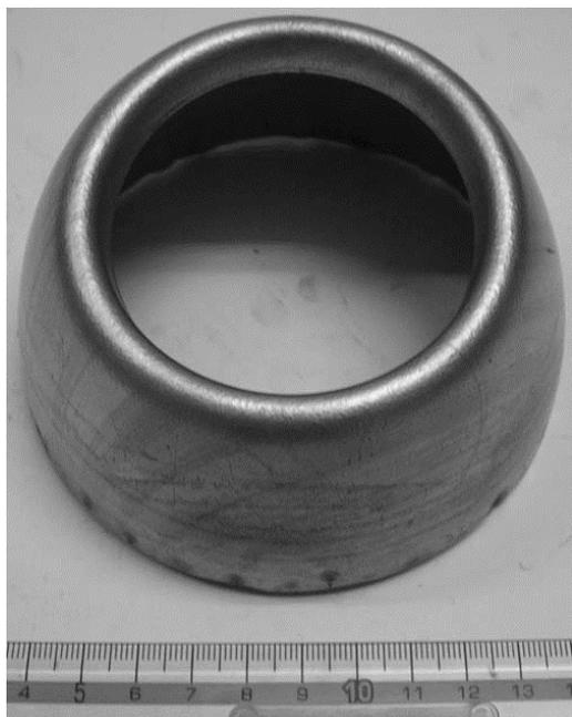
Рис. 5 Форма детали после 2-го перехода штамповки.
