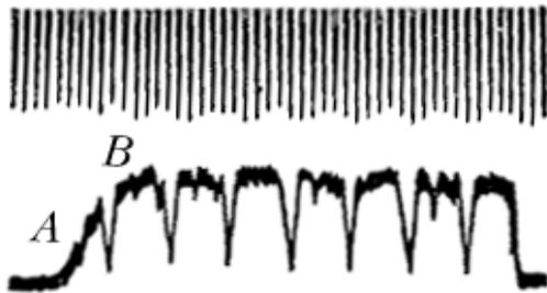
Рис.1. Осциллограмма изменения температуры в зоне контакта шлифовального круга.
