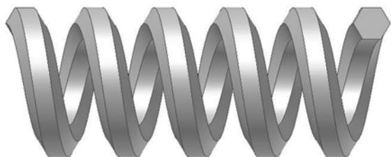
Рис. 1. Цилиндрическая спираль с шестигранным сечением.
