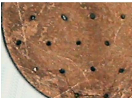
Рис. 1. Фрагмент брикета с внедренными алмазными зернами.
