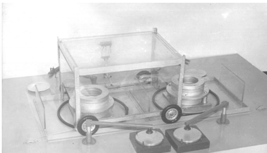
Действующая модель автоматизированной установки типа бронекмера.
