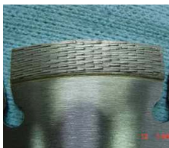
Рис. 1. Инструмент с упорядоченным размещением алмазных зерен.
