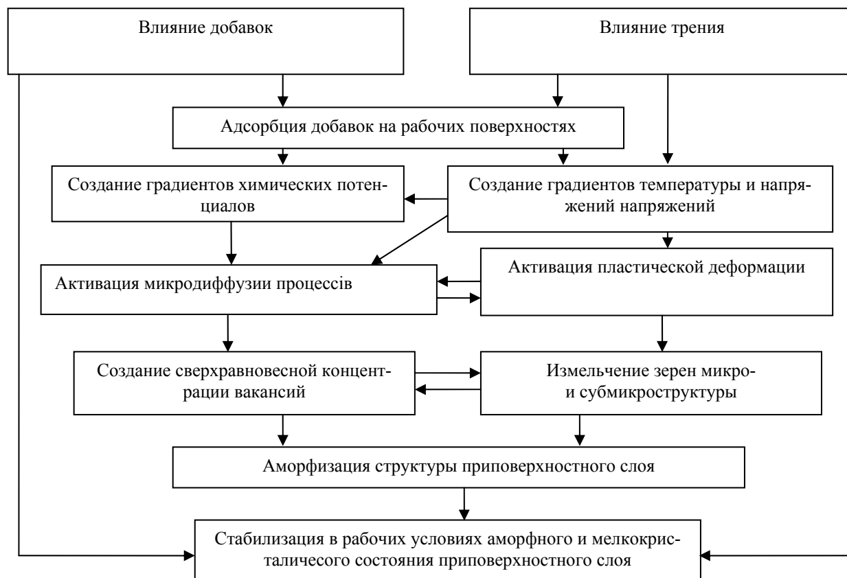
Рис. 2. Схема модели образования вторичных защитных структур аморфного типа в процессе трения с высокодисперсными добавками.
