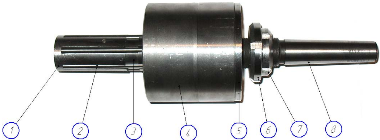
Рис. 1. Загальний вигляд інструменту для обробки переривчастих отворів поверхневим пластичним деформуванням: 1 – стакан; 2 – ролик; 3 – сепаратор; 4 – корпус; 5 – кришка; 6 - гайка регульовальна; 7 – гайка стопорна; 8 – стрижень.
