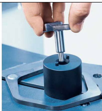
Рис. 8. Угловая ориентация заготовки по штифтам транспортной оснастки.
