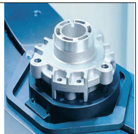
Рис. 9. Угловая ориентация транспортной оснастки по граням рамки.
