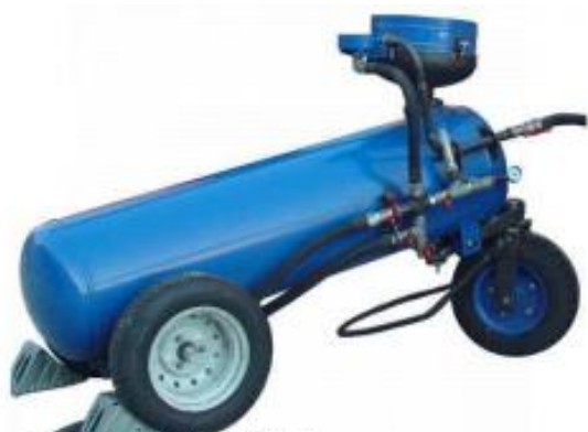
Рис. 1. Установка для струйно-абразивной обработки деталей с использованием давления сжатого воздуха до 2 МПа.
