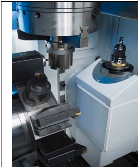
Рис. 4 Рабочая зона станка серии VLC позволяет установить до трёх инструментальных обрабатывающих модулей.
