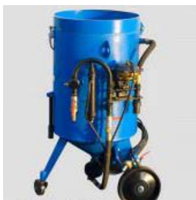
Рис. 2. Установка для струйно-абразивной обработки деталей с использованием давления сжатого воздуха до 0,6 Мпа.
