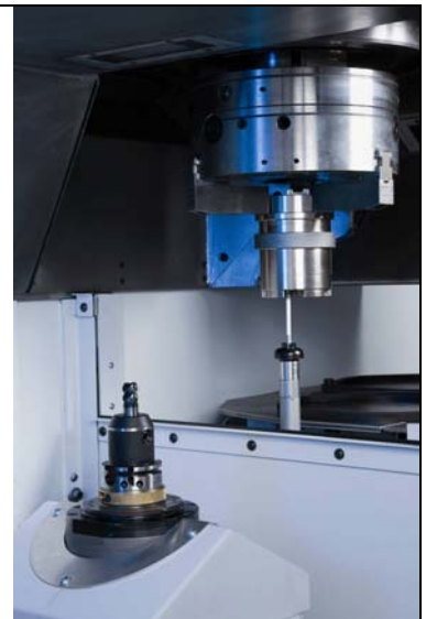
Рис. 6. Измерительный шуп позволяет с минимальными перемещениями рабочих органов измерять размеры обрабатываемой детали
