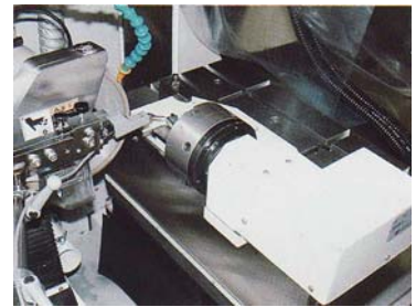
Рис. 6. Обработка детали в поворотной головке
