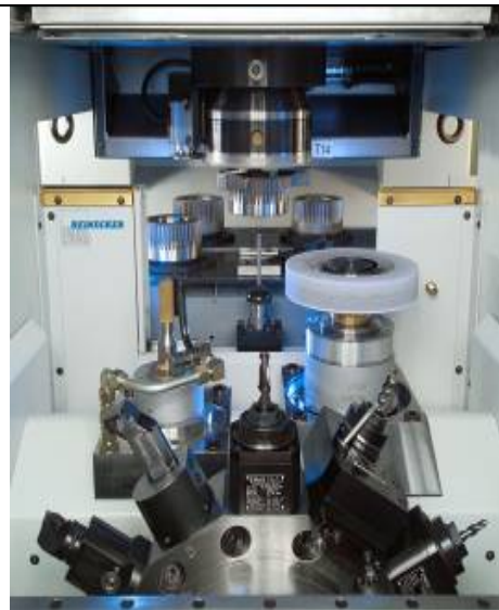
Рис. 5. В зависимости от поставленных задач, токарный станок может быть оснащён фрезерным, сверлильным, хонинговальным модулями или их комбинацией.
