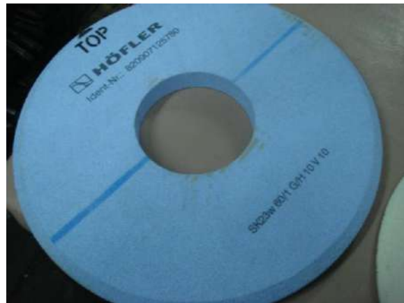
Рис. 3.7. Зубошліфувальний верстат (а) та спеціальний високопористий профільний абразивний круг (б)
