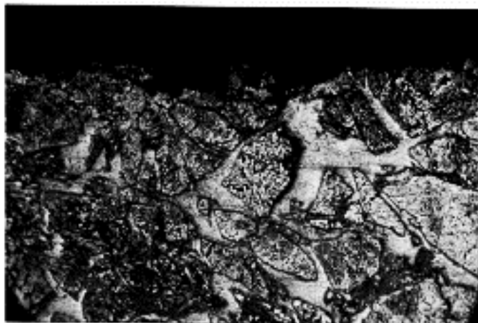
Рис. 3.17. Мікроструктура композиції «твердий сплав «Реліт» – мідь»
