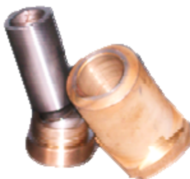
Рис. 3.26. Деталі пари тертя «поршень – циліндр (втулка корпусу)»
