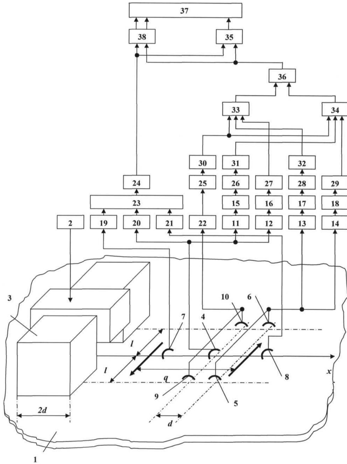
Корисна модель належить до автоматики та обчислювальної техніки та може бути використана для зчитування інформації, нанесеної у вигляді магнітних міток на пласкі металеві носії, наприклад прокат.
