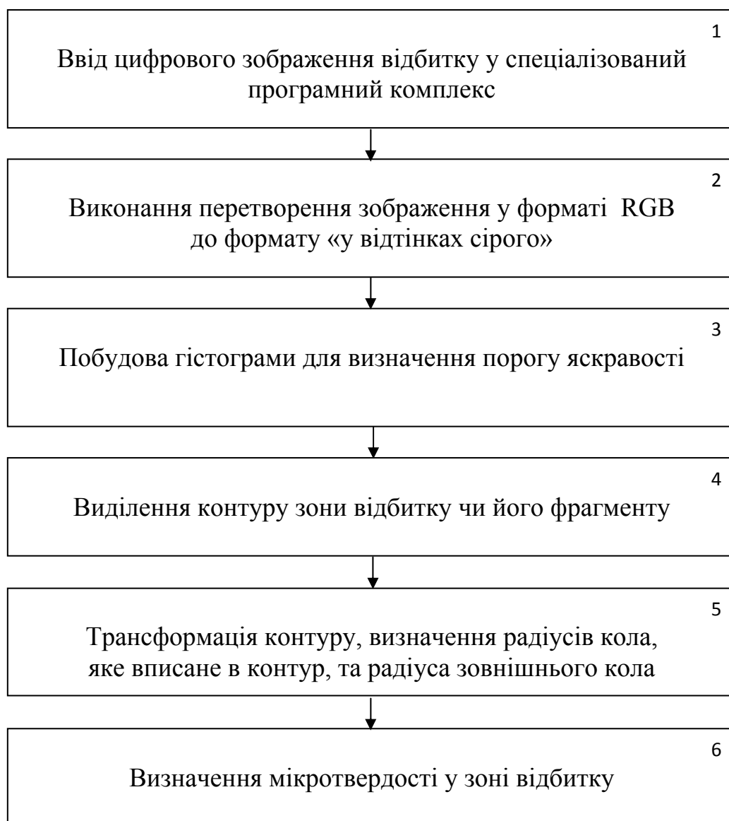
Рис. 2 – Фрагмент блок – схеми «внутрішньої зони» алгоритму, яка відображує склад основних операцій по визначенню значення мікротвердості у i – й зоні шліфу (відповідає блоку 6 алгоритму, що приведені на рис. 1.).
