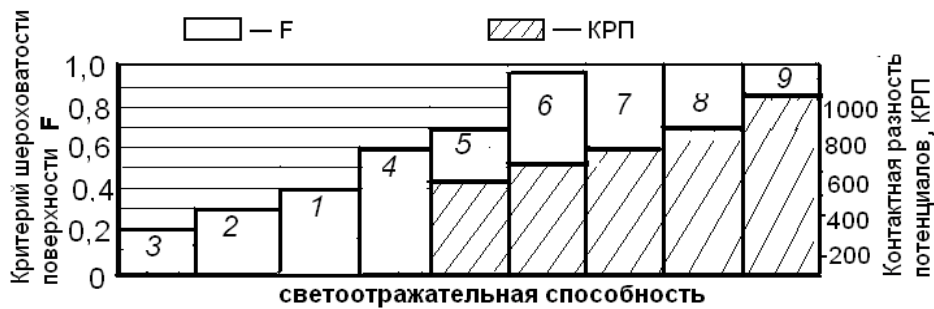
Рис. 3 – Характер изменения светоотражательной способности и параметров поверхности от методов обработки деталей из сплава АМГ-6: 1 – прокат; 2 – гидроабразивная обработка; 3 – обработка металлической дробью; 4 – фрезерование твердосплавной фрезой; 5 – фрезерование фрезой из эльбора; 6 – точение твердосплавным резцом; 7 – алмазное полирование; 8 – выглаживание; 9 – алмазное точение
