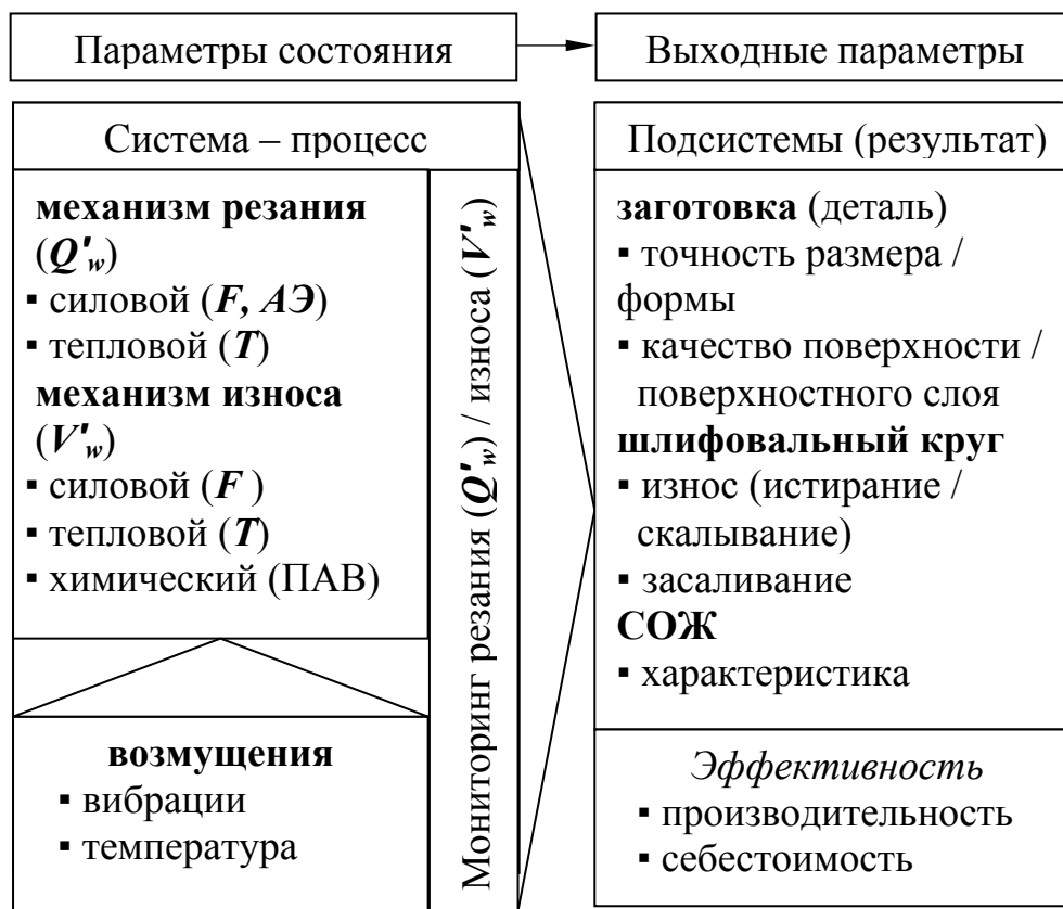
Рис. 4 – Информационная модель автоматизированной технологической системы шлифования: в дробных обозначениях режимных переменных указаны зарубежные [3] и отечественные обозначения
