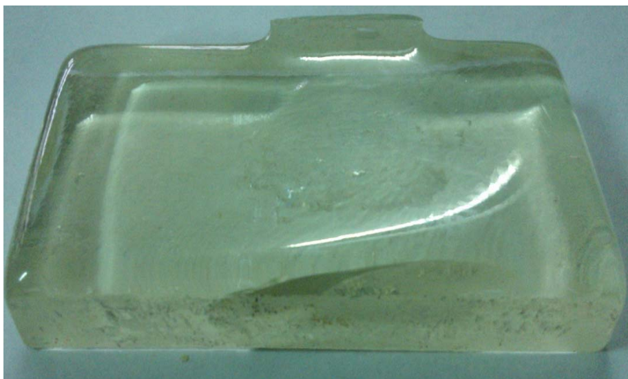
Рисунок – Зовнішній вигляд пластини склокристалічного матеріалу на основі дисилікату літію після термічної обробки
