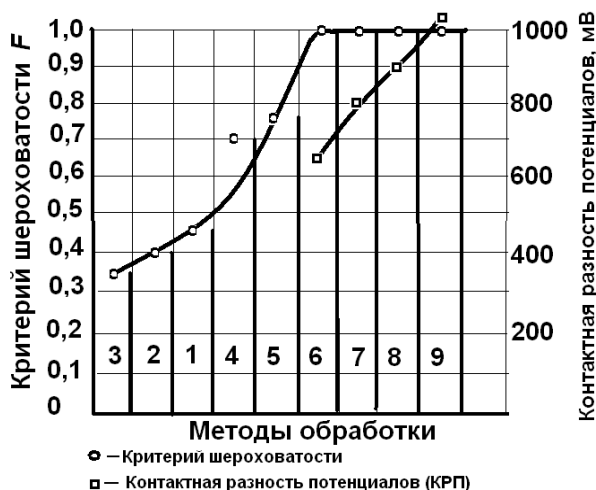
Рис. 2 – Зависимость критерия шероховатости поверхности и КРП от методов обработки деталей из сплава АМгб:
