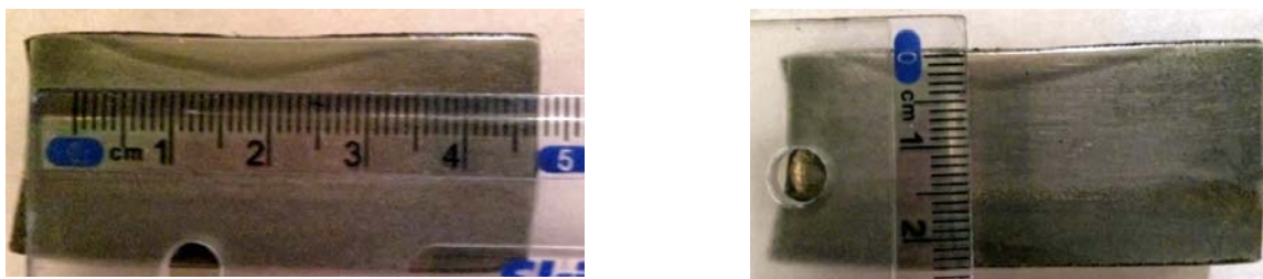
Рис. 1 – Образец, подвергнутый нагреву сканирующей плазменной дугой
