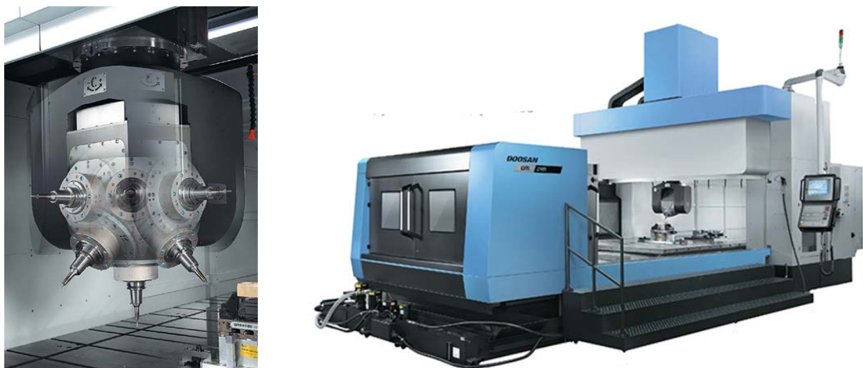
Рис. 2.1. Обробний центр Doosan VM 2740U
