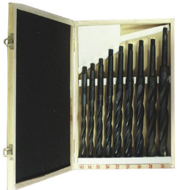
Рис. 2.22. Застосовувані різальні інструменти: кінцеві фрези (а), мітчик і плашка (б), свердла (в)
