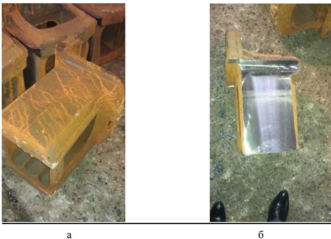
Рис. 2.7. Загальний вигляд заготовки (а) та обробленої деталі (б)
