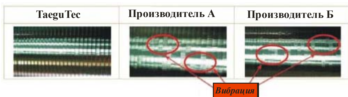
Рис. 6.29. Обработанная поверхность. Следы от вибрации
