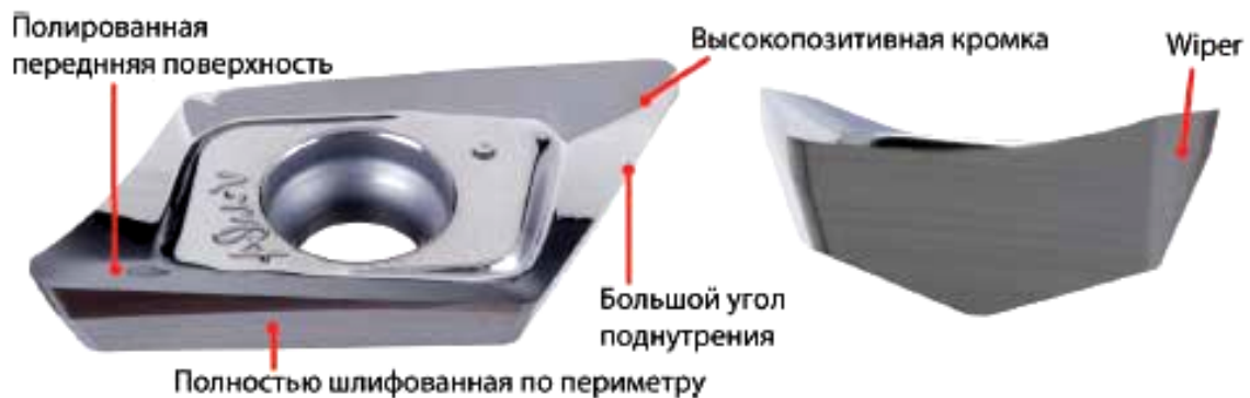
Рис. 6.77. Особенности пластины ХЕСТ 1605 R-AL
