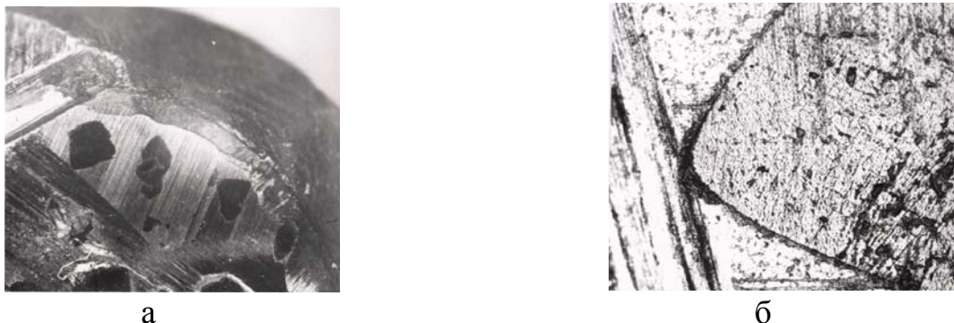
Рис.2. Рабочая поверхность алмазного правящего карандаша (темные участки на фотографии (а) алмазные зерна; на фотографии (б) показано алмазное зерно в увеличенном масштабе)
