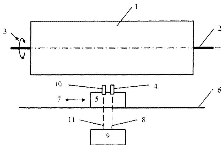
Корисна модель належить до целюлозно-паперової промисловості та призначена для вимірювання температури стінки сушильних циліндрів машин із виробництва паперу з одночасним вимірюванням його вологості.
