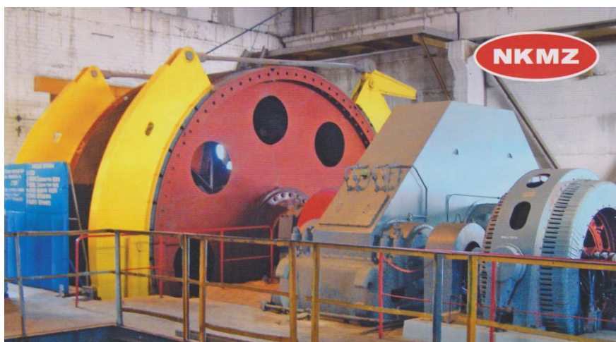
Рис. 1 – Шахтные подъемные машины типа МПБ с одним цилиндрическим неразрезным барабаном производства ЧАО «НКМЗ»
