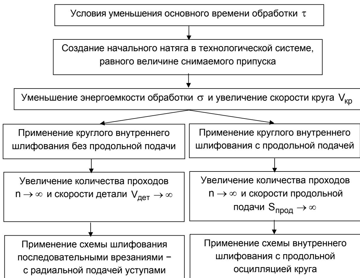
Рис. 3.36. Структурная схема условий уменьшения основного времени \tau при круглом внутреннем шлифовании по упругой схеме с начальным натягом в технологической системе (схема выхаживания)
