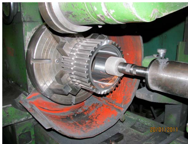
Рис. 3.30. Внутреннее шлифование сателлита
