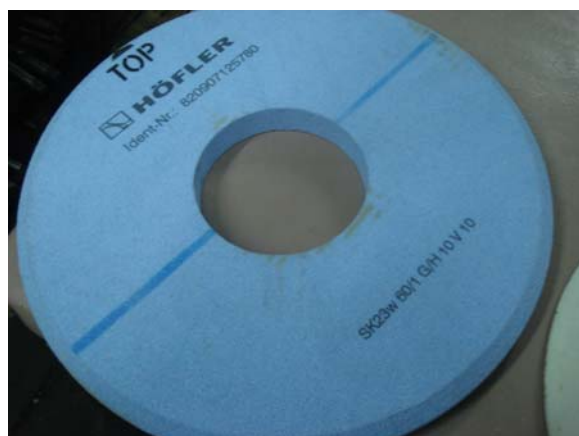
Рис. 3.4. Общий вид круга для шлифования по методу профильного копирования
