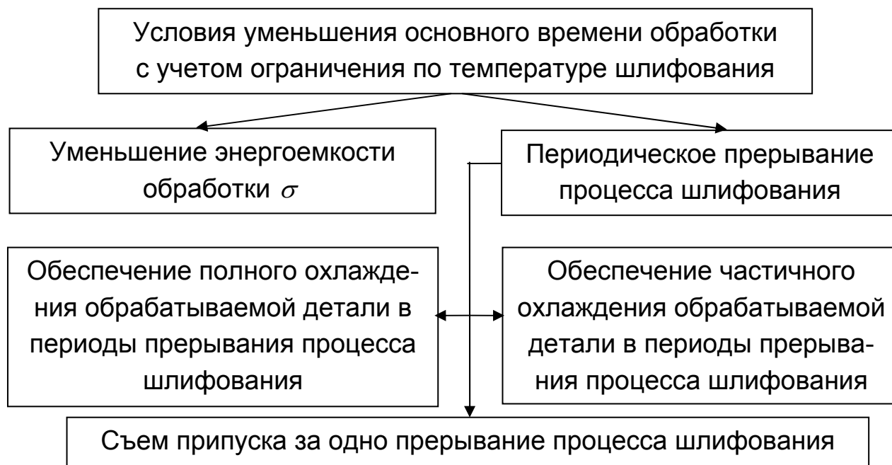
Рис. 2.18. Структурная схема условий уменьшения основного времени обработки с учетом ограничения по температуре шлифования
