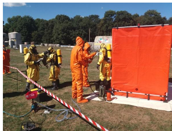
Рис. 7 – Проведення деконтамінаційної обробки захисного одягу групи відбору проб
