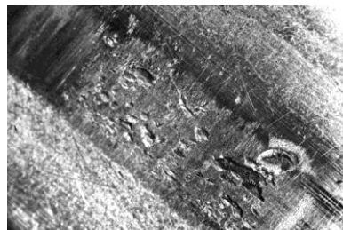
Рисунок 5.12 – Внешний вид выкрашивания поверхности зуба (стократное увеличение)
