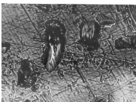
Рисунок 6.5 – Следы абразивных зерен карбида кремния зеленого (63С 63П) на полированных поверхностях латунных образцов, обработанных в течение 20 с: а – в закрепленном состоянии относительно струи; б – в свободном состоянии. Ув. × 1100
