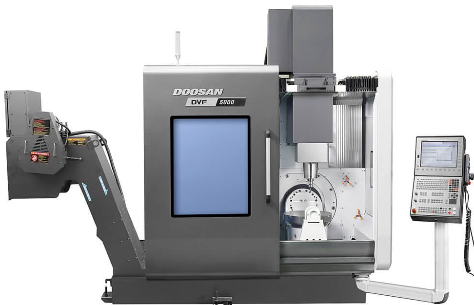
Рисунок 2.19 – Компактные вертикальные обрабатывающие центры DOOSAN серии DVF
