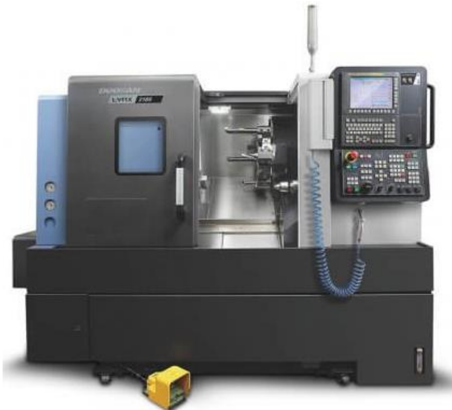
Рисунок 2.31 – Компактный горизонтальный токарный центр LYNX 2100
