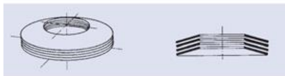
Рисунок 1.1 – Пакет тарельчатых пружин
