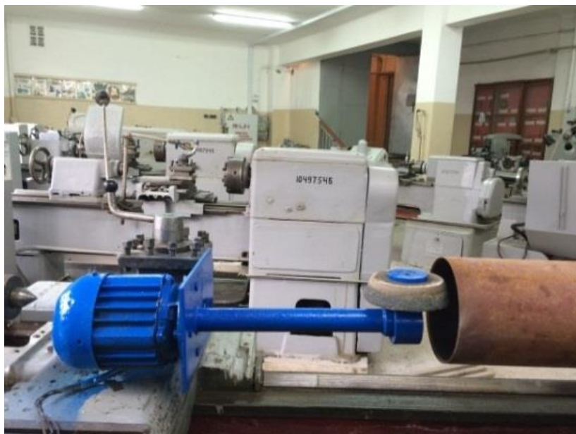
Рисунок 7.8 – Схема обработки отверстия в цилиндре
