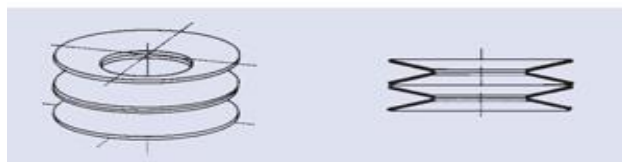
Рисунок 1.2 – Блок тарельчатых пружин
