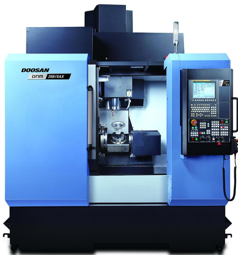
Рисунок 2.18 – Вертикально-фрезерный 5-координатный станок DOOSAN серии DNM 200/5AX
