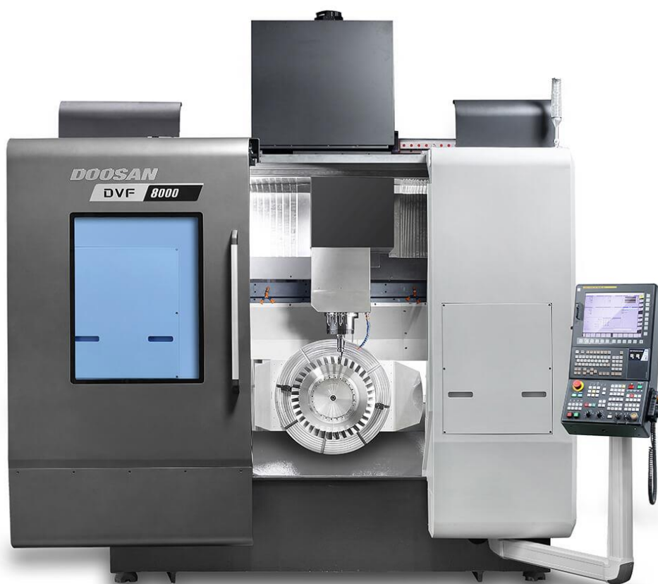
Рисунок 2.20 – 5-осевой вертикальный обрабатывающий центр DVF 8000
