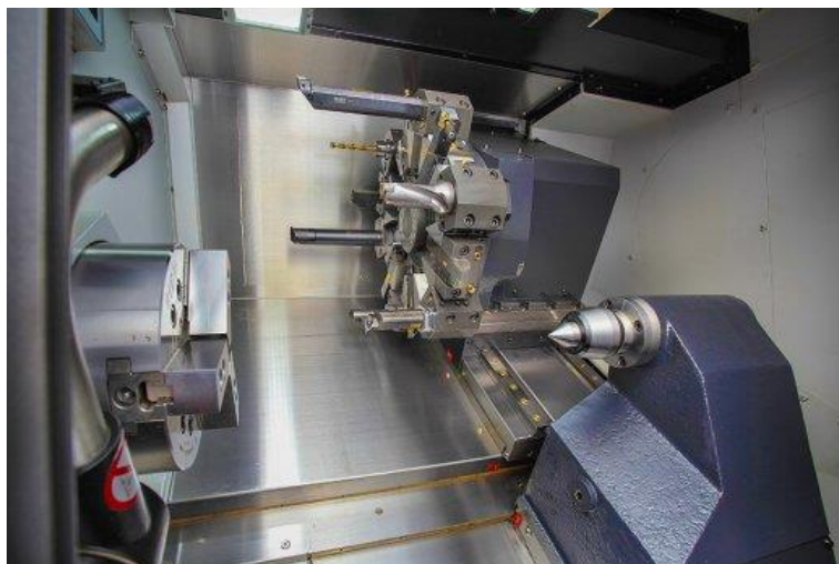
Рисунок 2.30 – Возможна обработка с перехватом детали
