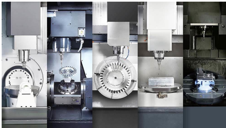
Рисунок 2.17 – Изготовление сложных деталей за один установ на оборудовании для 5-осевой обработки
