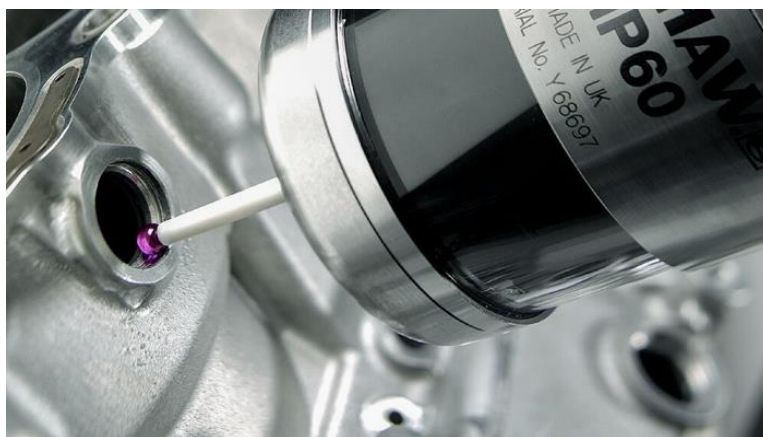
Рисунок 2.23 – Применение пробора Renishaw для контактного измерения параметров обработанного отверстия
