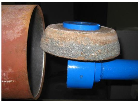
Рисунок 7.19 – Схема внутреннего шлифования
