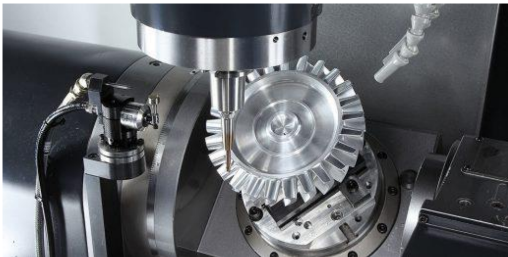
Рисунок 2.8 – Пример обработки на 5-осевом фрезерном обрабатывающем центре DNM 5AX
