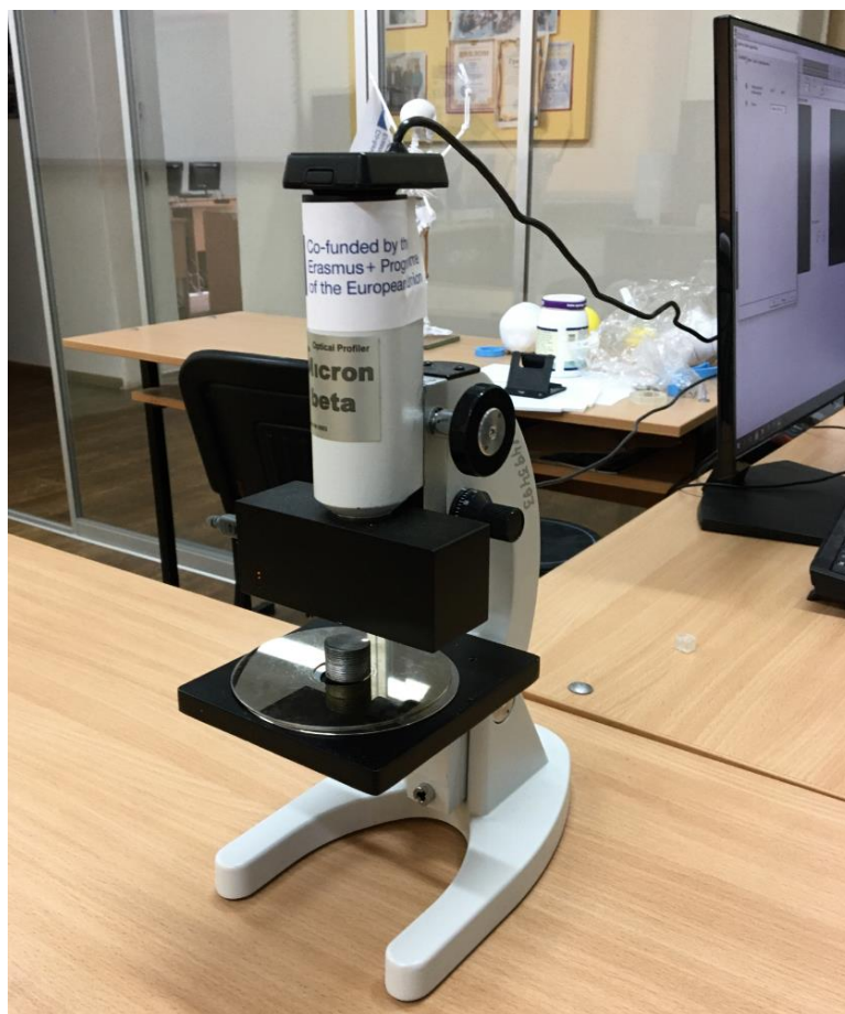
Рисунок 7.20 – Проффилограф-профилометр модели Optical Profiler Micron beta
