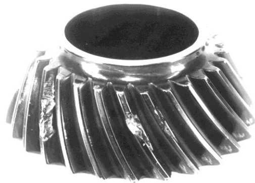
Рисунок 5.10 – Внешний вид разрушенного зуба спирально-конической шестерни
