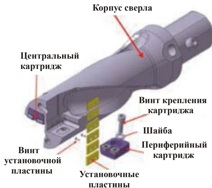
Рисунок 2. – Сверло серии T-Drill с картриджами
