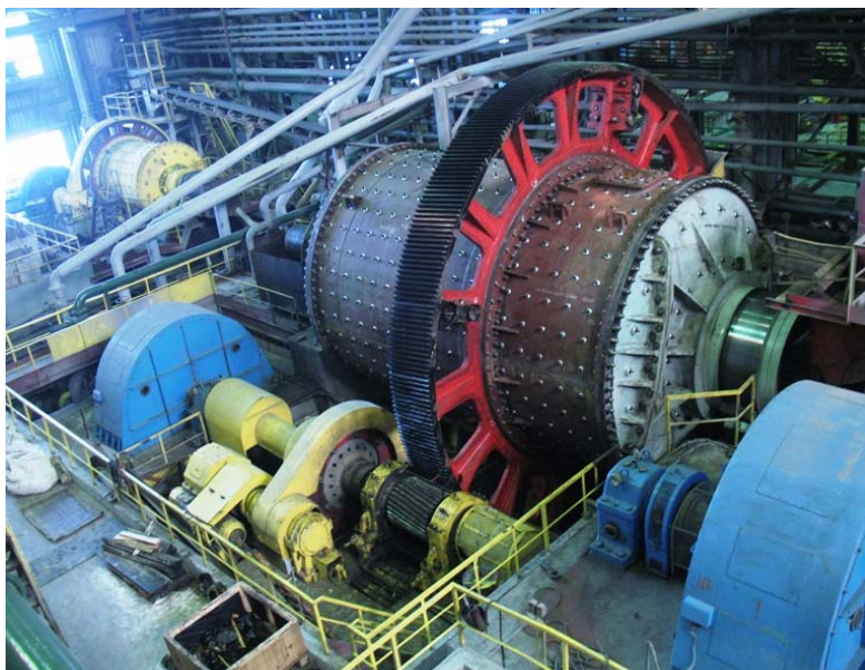
Рисунок 1. – Рудорозмельний млин з зубчастими передачами виготовлений по інноваційній технології
