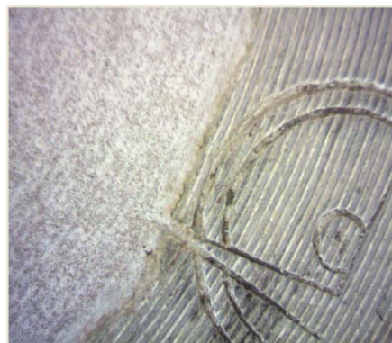
а б Рисунок 2. – Чашечный алмазный шлифовальный круг в сборе с основной оснасткой для избирательного МДО ( а ) и фрагмент под микроскопом МБС-9 ( x 10 ), зона покрытия слева ( б )
