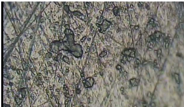
Рисунок 1. – Структура покрытия на основе бронзы ПРБрО10Ф1 с добавкой модификатора наноалмаз-пироуглерод-Си; \times 200
