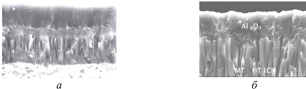
Рисунок 2. – Микроструктура фрезерного сплава TT6290 (а) и токарного сплава TT7310 (б)
