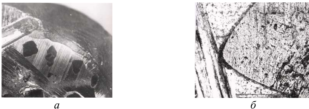
Рисунок 2. – Рабочая поверхность алмазного правящего карандаша (темные участки на фотографии (а) алмазные зерна; на фотографии (б) показано алмазное зерно в увеличенном масштабе)
