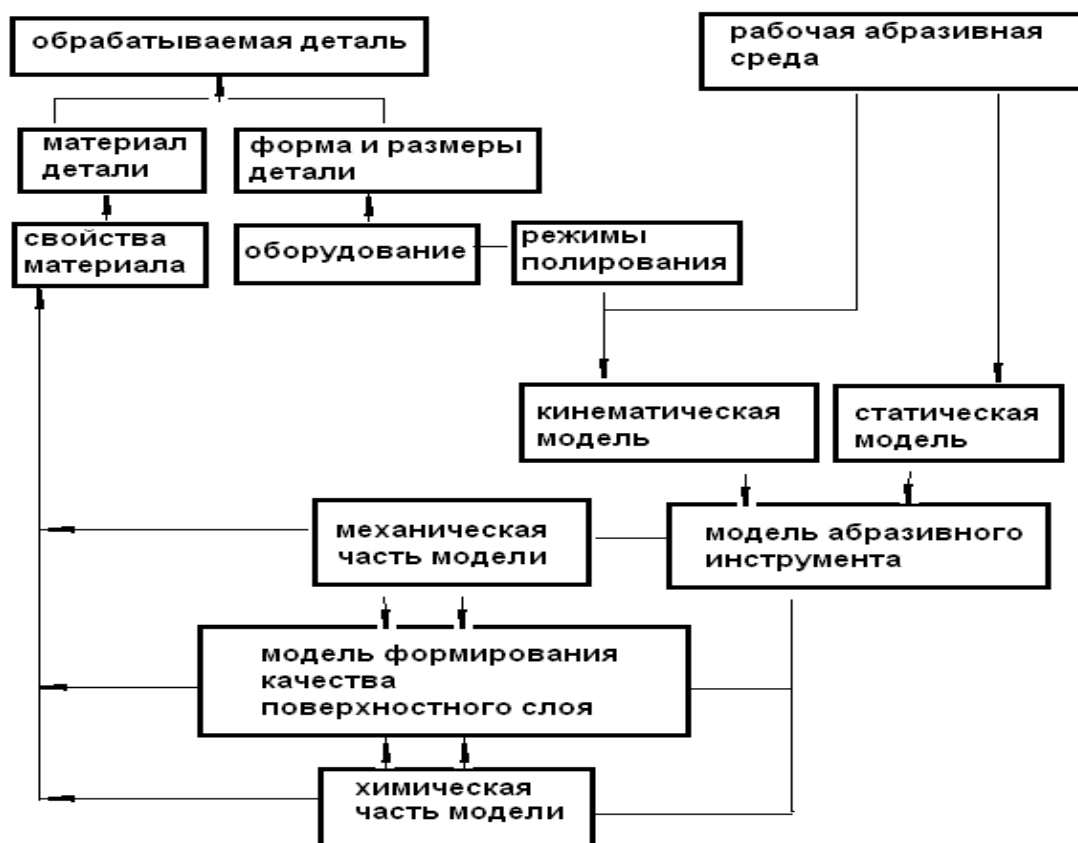
Рисунок 1 – Схема формирования геометрии и физико-химического состояния поверхностного слоя при обработке свободным абразивом
