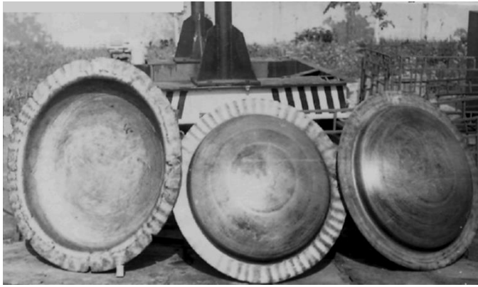
Рисунок 3 – Деталі діаметром 700 і 900 мм (а) та дослідні зразки (б), що виготовлені методом штампування за схемою роздачі напівфабрикату
