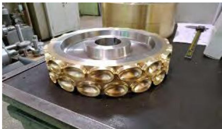
Рисунок 2 – Деталь – кільце вирубне (матеріал – латунь ЛС59). Режим різання: n = 11\ 000 об./хв., S = 600 мм/хв. Інструмент – фреза твердосплавна DHF ВТВ0404. Застосовуване обладнання – FINETECH SMW1670 (Тайвань)
