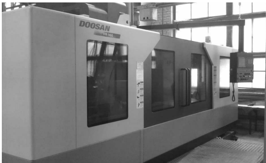
Рисунок 3 – Верстат із ЧПУ типу "обробний центр" DOOSAN VM960 (виробництва Південної Кореї)
