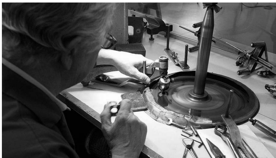
Рисунок 26 – Процес огранювання природного алмазу в діамант
