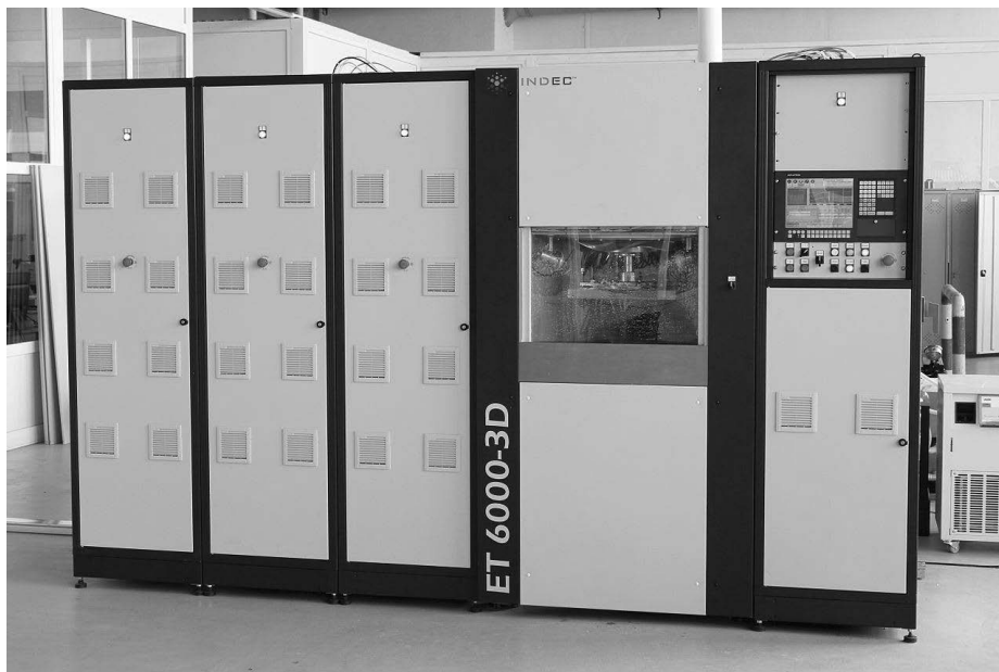
Рисунок 7 – Електрохімічний верстат ET6000-3D
