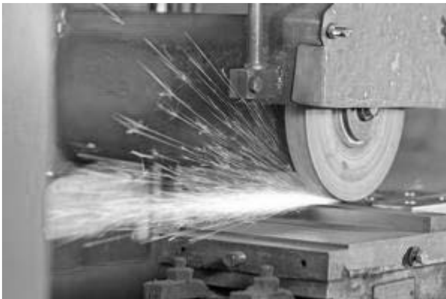
Рисунок 6 – Схема здійснення процесу шліфування
