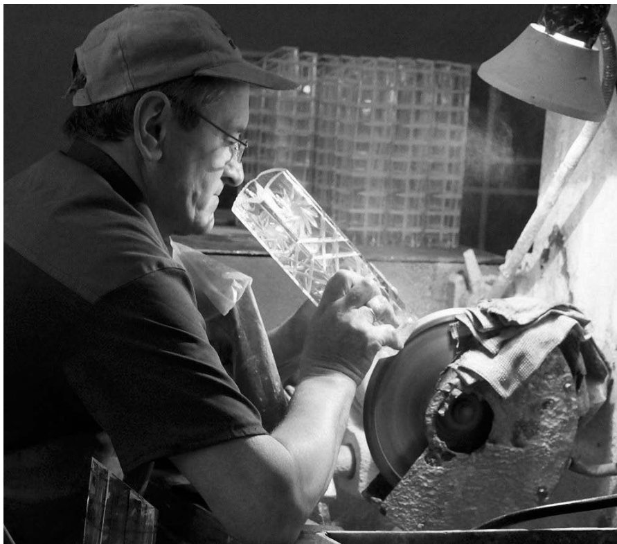
Рисунок 31 – Нарізування граней на поверхнях виробу із кристалю
