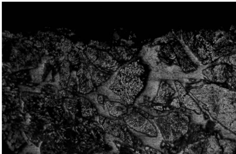
Рисунок 68 – Мікроструктура композиції "твердий сплав "Реліт" – мідь"
