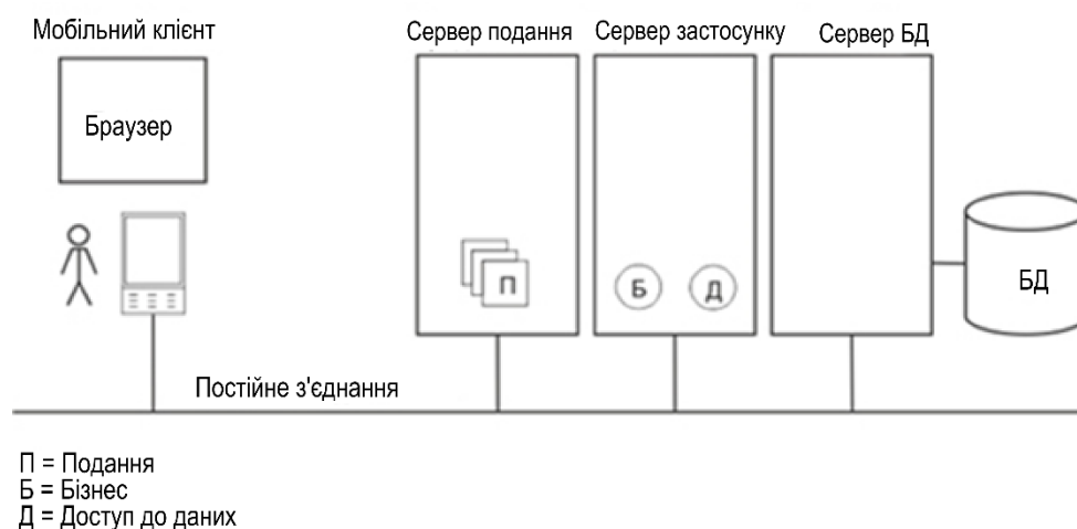
Рис. 2.14. Нульова трирівнева архітектура безперервного під'єднання
