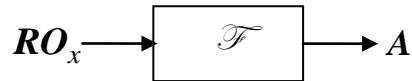
Рис. 7.11. Нелінійний оператор \mathcal{F} утворення загальних складних неметричних ознак за початковою матрицею RO_x
