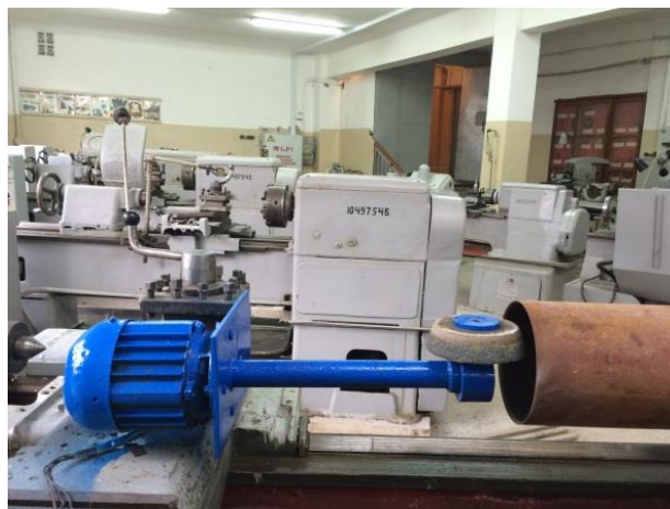
Рис. 1 – Схема обробки шліфуванням отвору у циліндрі
