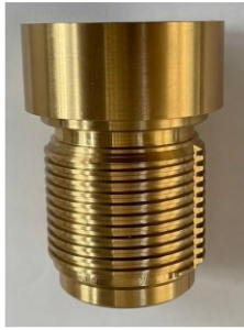
Рисунок 2 – Штуцер. Матеріал – берилієва бронза БрБНТ: n=1150 об/хв., S=0,05 мм/об., t=0,5 мм; Ra=0,8 мкм. Обладнання – EX910, TAKISAWA (Тайвань)
