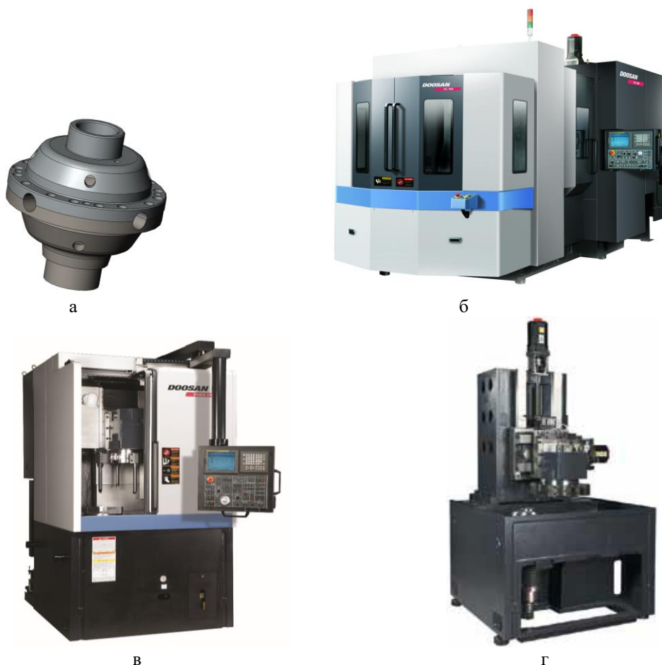
Рис. 6. Деталь «Чашка міжколісного диференціала» (а), вертикальний токарний обробний центр PUMA V400L (б), вертикальний токарний обробний центр із фрезерною функцією PUMA V400ML (в) та горизонтальний фрезерний обробний центр DOOSAN HC 400 (г)
