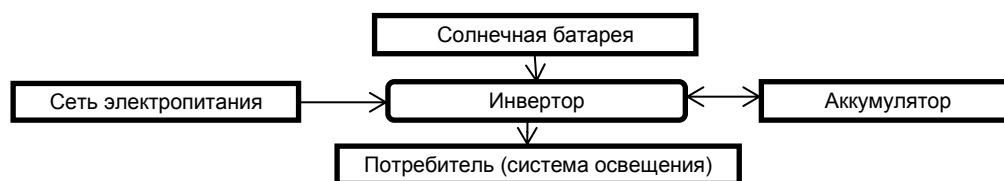
Рис. Блок-схема системы электроснабжения
