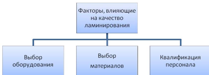
Рис. 2 Причины возникновения брака при ламинировании
