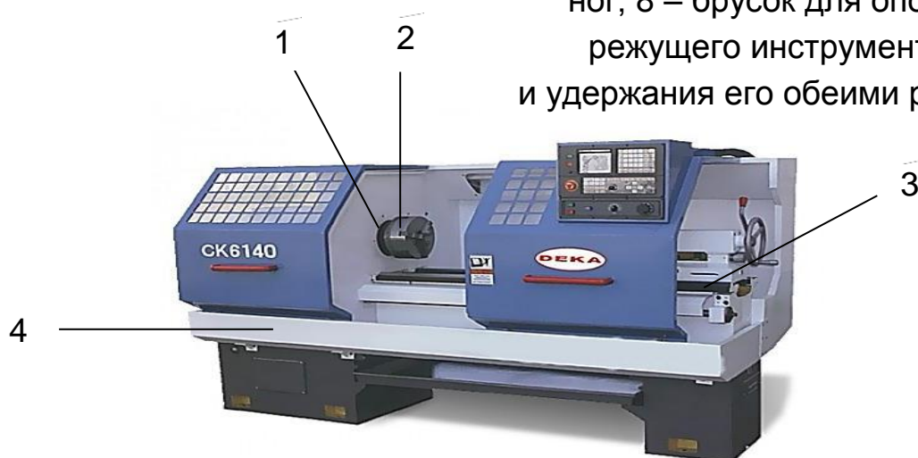
Рис. А3. Современный токарный станок фирмы DEKA: 1 – шпиндель (вал в корпусе передней бабки); 2 – патрон для крепления заготовки; 3 – задняя бабка; 4 – станина
